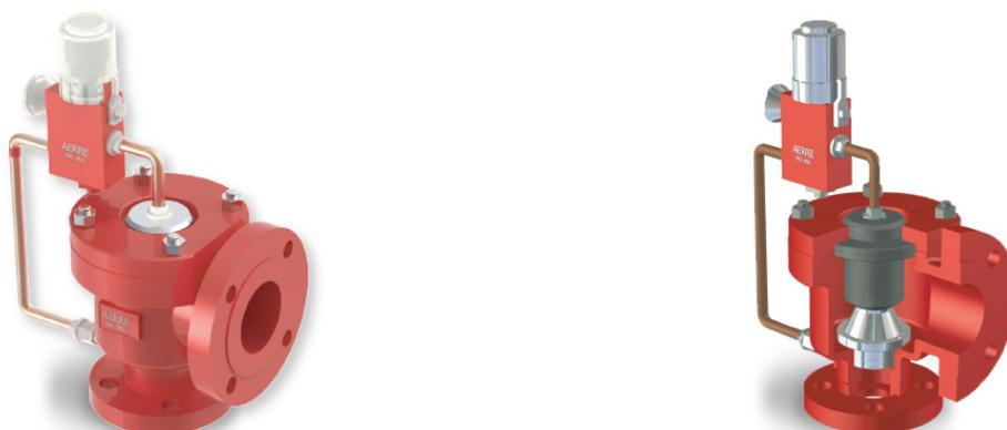
Diseñada bajo las normas API 520, API 526 y API 527, con conexiones bridadas, la serie 2100 es una válvula accionada por piloto a diferencia de las convencionales de resorte. Dispone de conexiones bridadas según la norma ANSI B16.5.
